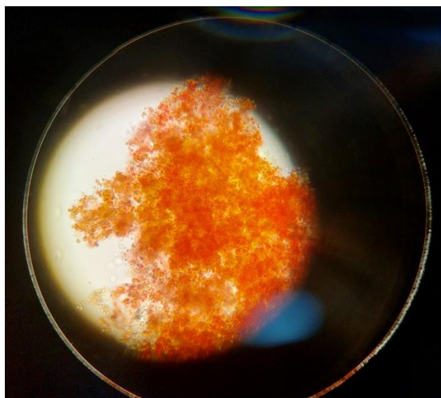
Figura 4.33. Biosorción de microalga, teñida de colorante rojo Congo, tras la remoción del colorante.
