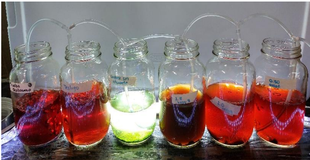
Figura 3.10. Sistema de biorreactores para el proceso de Biorremediación incluyendo el biorreactor de Quitosano.
