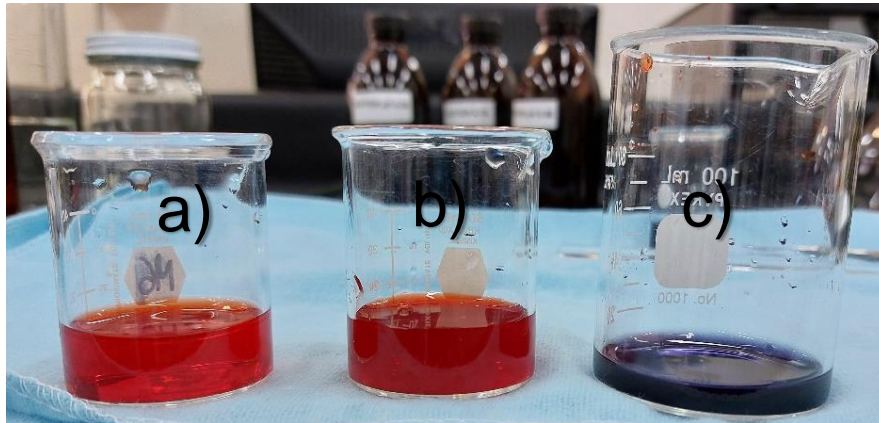
Figura 4.5. Tonalidades del colorante. a) colorante a pH básico, b) colorante a pH neutro, y c) colorante a pH ácido.
