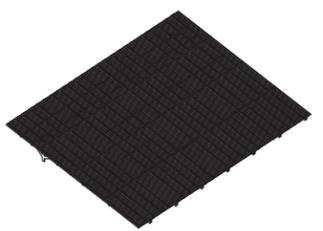
07. Lámina de acero galvanizada calibre 22, de 1.10m x 6.10m, con colocación de pijas a cada 50cm, que descansa sobre una cama de barrote de madera de pino de 10cm x 5cm.
