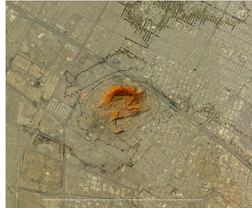
Imagen 121 Mapa de elevación elaborado en QGIS que resalta en color naranja el relieve del Cerro del Peñón y sus alrededores, se aprecia la inclinación pronunciada al norte y el espacio aplanado por la actividad minera en el centro del cerro ocupado actualmente por la colonia Paraíso y el Hoyo. Elaborado por Ulises Gutiérrez (2022)
