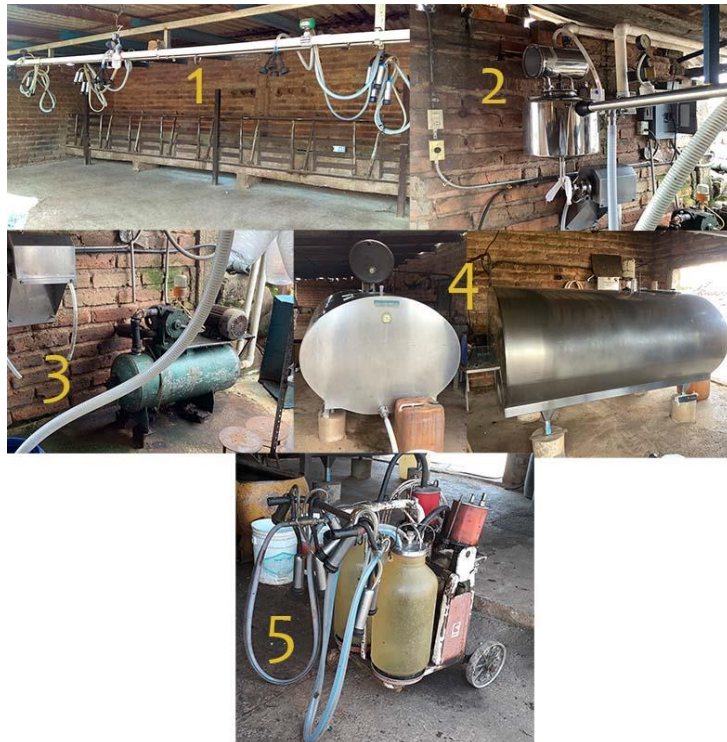
A4.1.8 Activo Fijo: Equipo de Ordeña (1,2y3) Tanque enfriador de leche (4) Carro de ordeño de luz y gasolina (5)
