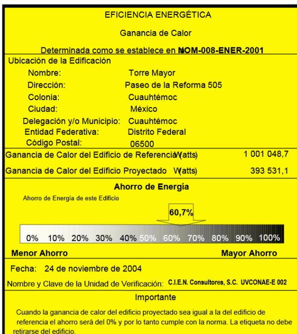
Figura 19. Ejemplo de etiqueta de eficiencia energética de la NOM-008-ENER-2001
