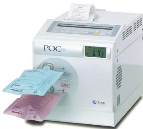
Figura 5. Espectrofotómetro. La bolsa azul corresponde a la muestra basal y la rosa a la realizada a los 20 minutos de administrar la Urea con \text{C}^{13} .
