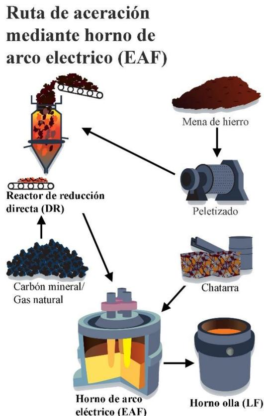
Figura 1.- Ruta integrada de aceración reducción directa-horno de arco eléctrico. Adaptada de [3].
