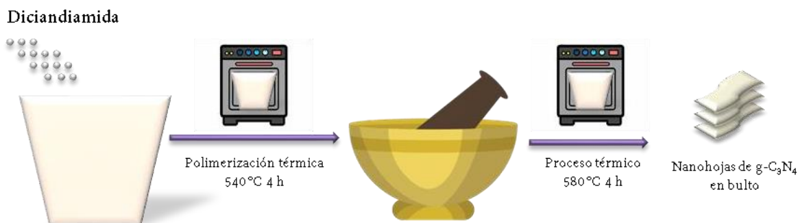
Figura 3.2. Representación esquemática del proceso de síntesis del compuesto g\text{-C}_3\text{N}_4 .
