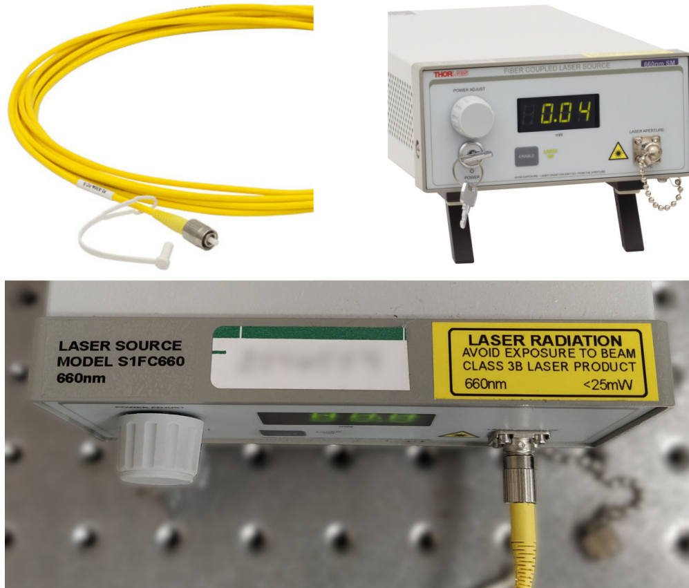
Figura 4.3: Equipo adicional para el funcionamiento del simulador de telescopio. Arriba: fibra óptica y fuente láser (Thorlabs 2023b,c). Abajo: fuente láser utilizada con el simulador durante el trabajo experimental.
