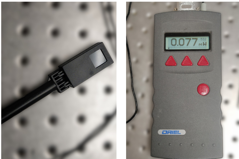
Figura 4.9: Equipo para la medición de luz. Izquierda: detector. Derecha: monitor.
