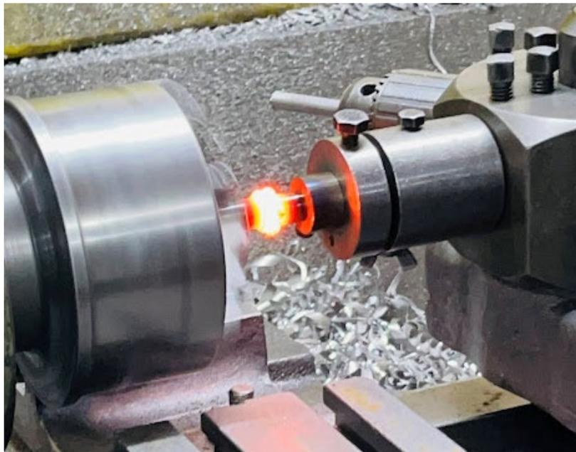
**Figura 3.3.** Proceso experimental de soldadura por fricción rotativa.
