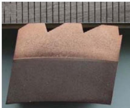
**Figura 2.13.** Imagen macroscópica de la unión disímil de latón-acero en soldadura radial por fricción [20].
