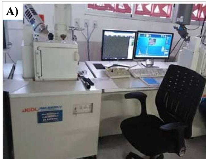
**Figura 3.9.** Microscopio electrónico de barrido utilizado: A) JEOL JMS-5900LV (USAI-FQ-UNAM).
