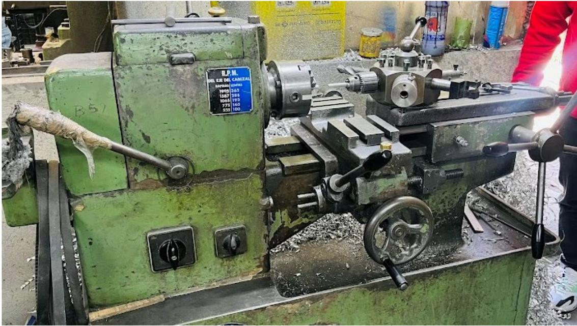
**Figura 3.2.** Torno revolver de forma UROLA 25 utilizado para la unión por fricción rotativa.
