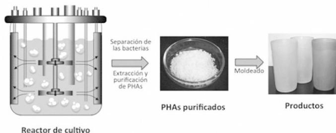
Figura 2. Esquema de la producción de bioplásticos usando a la bacteria *Azotobacter vinelandii*.
