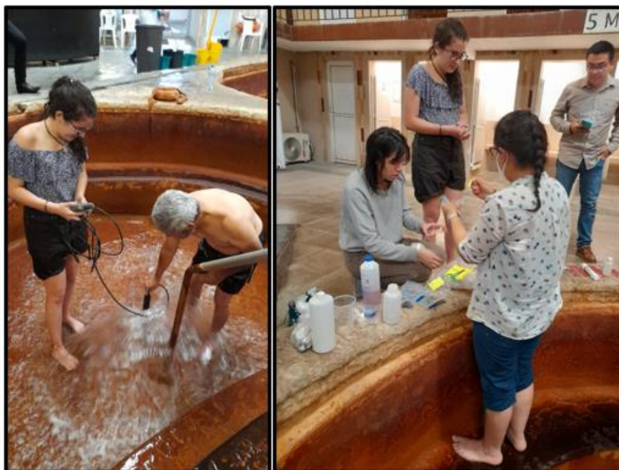
Figura 22. Toma de datos fisicoquímicos con sonda (izquierda) y llenado de botellas para análisis en laboratorio (derecha).
