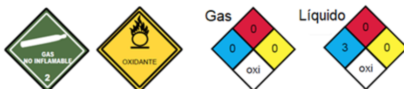
Figura 42. Rombos de seguridad de oxígeno medicinal (Infra Médigas, 2002).
