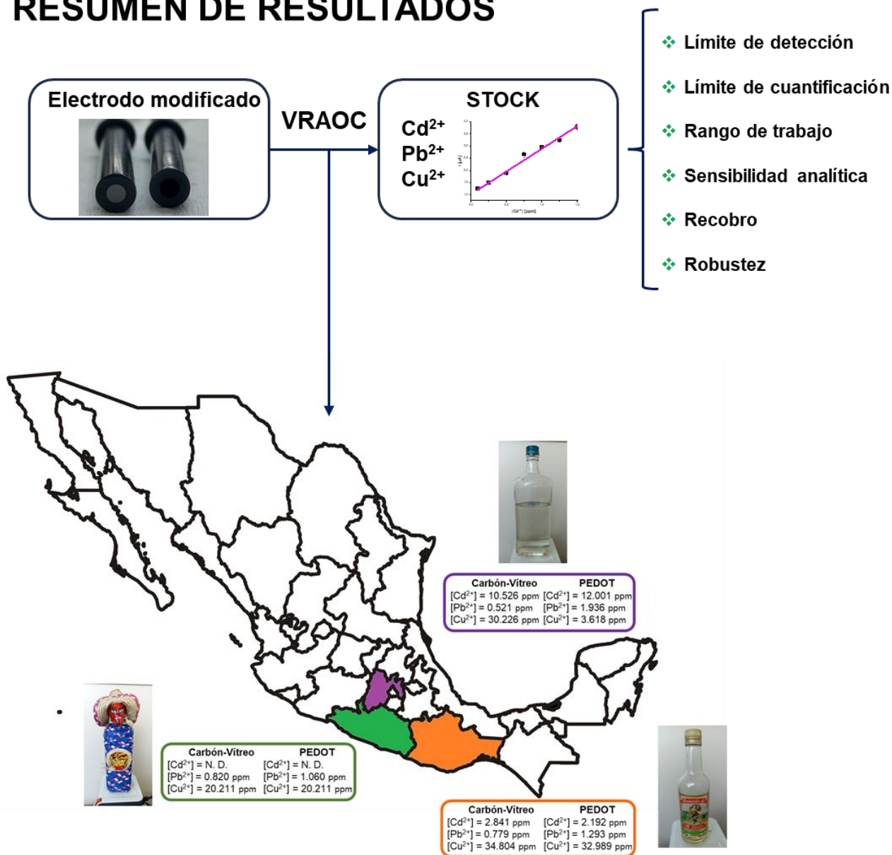
Figura 39. Resumen de resultados de la modificación del electrodo, una curva de calibración representativa, y resultados para cada mezcal analizado según su estado de procedencia.
