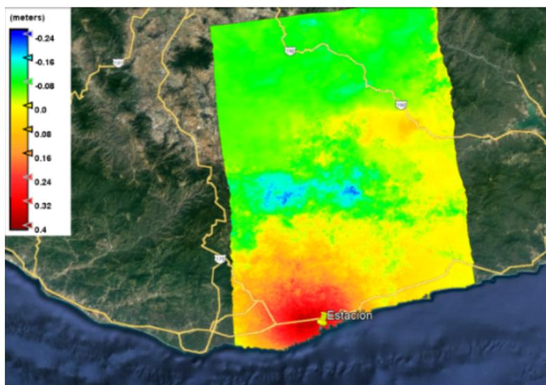
**Figura 5.9:** Mapa de desplazamientos en Huatulco, junto con la estación mareográfica. Este mapa contiene una escala métrica, por lo que el desplazamiento sobre la superficie máxima fue de 40 centímetros.
