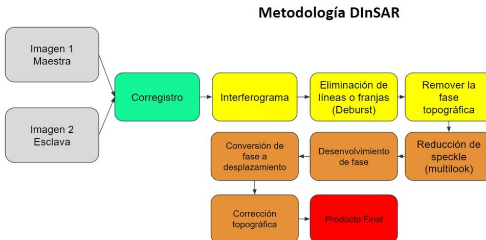
**Figura 4.1:** Diagrama de flujo simplificado del procesamiento DInSAR.
