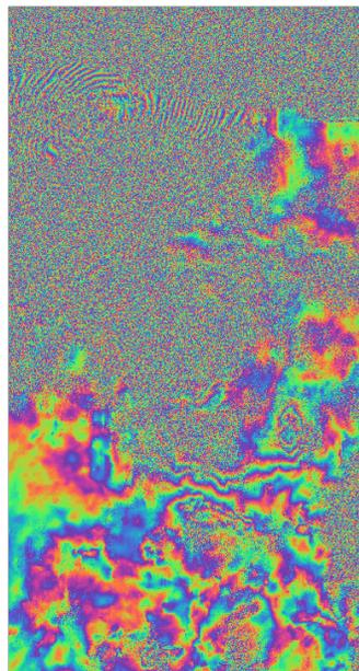
**Figura 5.3:** La imagen muestra la diferencia de fase entre las imágenes utilizadas después del filtrado y multilooking. Se observa que son más visibles las franjas interferométricas, así como zonas con alta decorrelación por el cambio de geometría en el periodo estudiado
