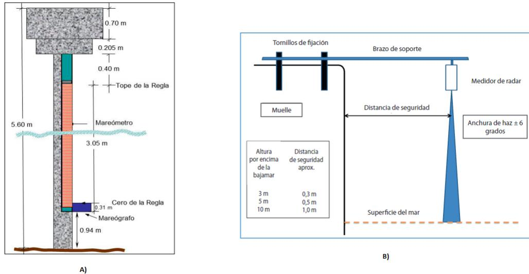
**Figura 1.2:** La figura A hace referencia a un mareógrafo tradicional con regla y todos sus componentes, la figura B hace referencia a un mareógrafo más nuevo el cual cuenta con un sistema de radar. Modificadas de : (UNESCO, 2016) y (HIDRONAV, 2013)
