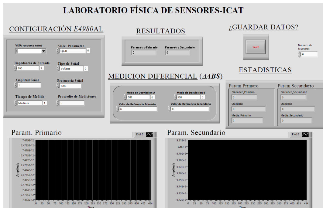
Fig. 5. 3 Panel de control principal del instrumento virtual (VI) desarrollado para la manipulación del LCR. Se observa las diferentes pestañas que permiten configurar y automatizar la medición experimental. Las ventanas de parámetro primario y secundario despliegan las señales obtenidas en tiempo real.
