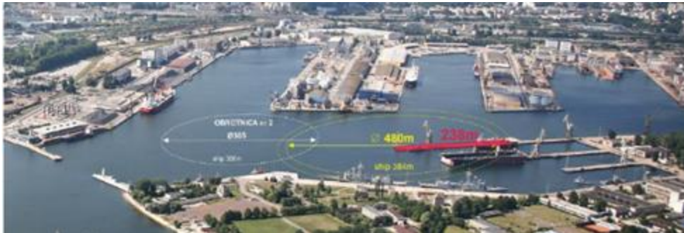
Ilustración 13. Visualización del concepto de ampliación de la dársena de ciaboga No. 2 en el puerto de Gdynia, Polonia. Fuente: Capacity analysis of the selected track system in partially ordered space (Mieloszyk et al., 2019).
