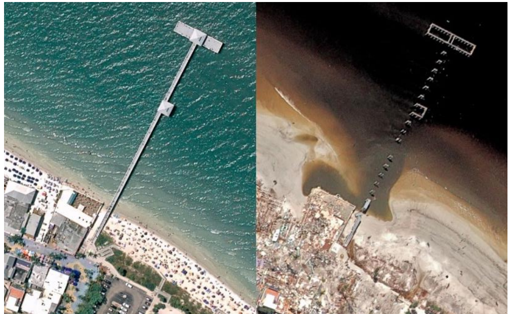
Ilustración 7. Muelle de Fort Meyers, Florida, EUA. Antes y después del huracán IAN de 2022. Fuente: Elaboración propia con imágenes de Google
