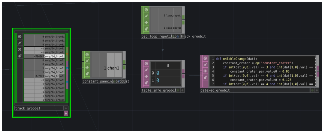
Imagen 54. Detalle de la programación en TD para recibir información del bucle.
