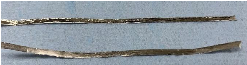
Figura 25. Imagen de ambas caras de la cinta vítrea, donde la cinta superior presenta mayor brillo que la inferior.
