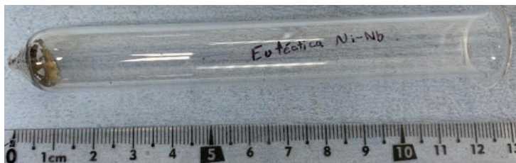
Figura 15. Imagen de crisol empleado en el proceso de melt-spinning.
