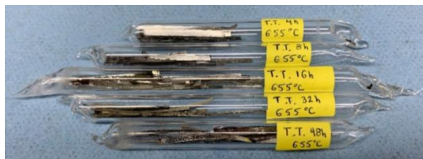
Figura 18. Imagen de encapsulados de cinta vítrea bajo atmósfera de Ar.
