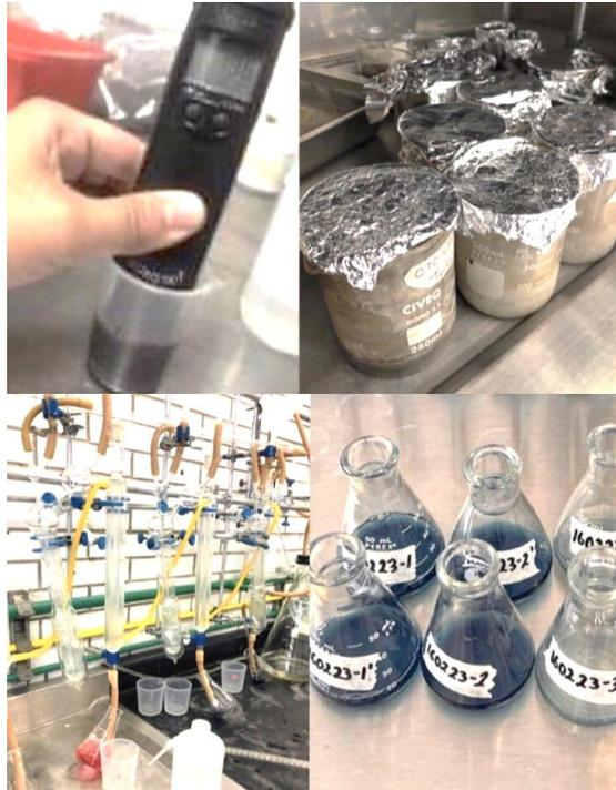
*Figura 16. Parámetros edáficos determinados en laboratorio. A: pH; B: Humedad; C: Nitrógeno total y D. Fósforo total (Ilustración propia)*
