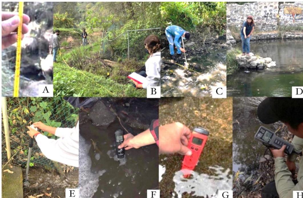
Figura 14. Parámetros in situ. A: Temperatura ambiente; B: Medición del transecto; C: Ancho del cauce; D: Traspacidad; E: Velocidad del cauce; F: Conductividad; G: pH y temperatura y H: Oxígeno disuelto (Ilustración propia)
