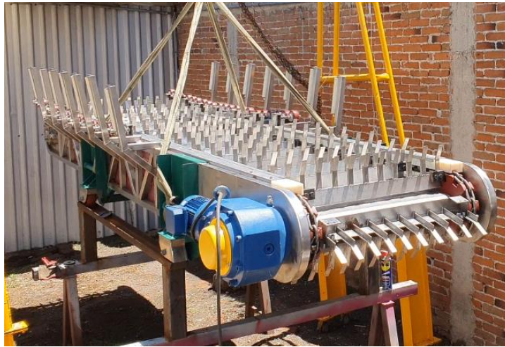
Imagen 40 Prototipo final del subsistema Extractor completamente ensamblado. Elaboración propia.
