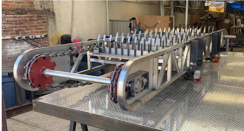
Imagen 38 Primeras etapas de manufactura y ensamble. Estructura - Tren motriz. Elaboración propia.
