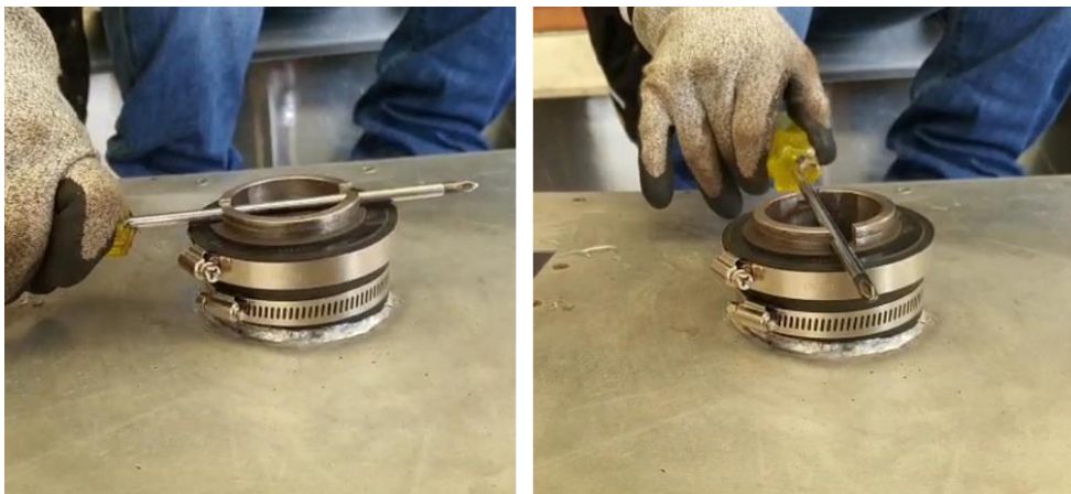
Imagen 67 Solución sello del eje del sistema de giro. Elaboración propia.
