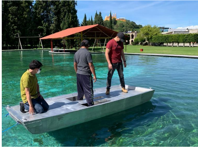
Imagen 62 Prueba flotabilidad de casco del barco. Elaboración propia.
