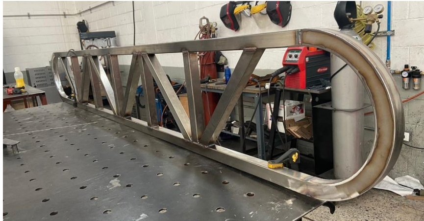
Imagen 29 Fabricación estructura lateral. Elaboración propia.
