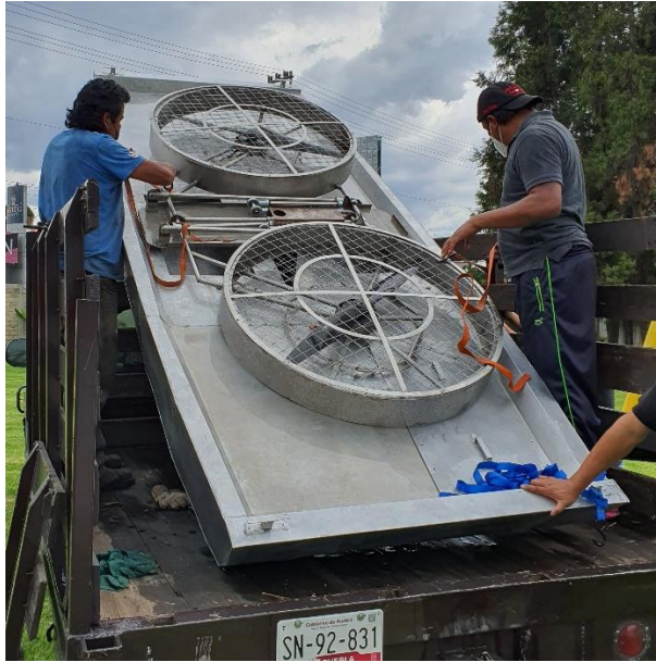
Imagen 59 Evaluación de rigidez en situaciones de inclinación. Elaboración propia.
