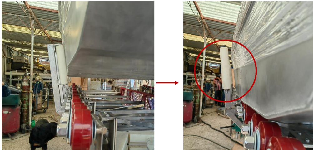
Imagen 46 Solución giro de rodillos guía. Elaboración propia.
