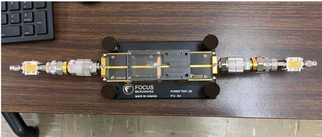
Figura 2.9. Conexión para caracterización en CD.
