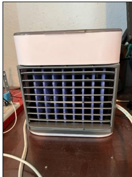
Figura 16. Actuador comercial de acondicionamiento de aire por enfriamiento evaporativo marca Artic Air Ultra 18008.
