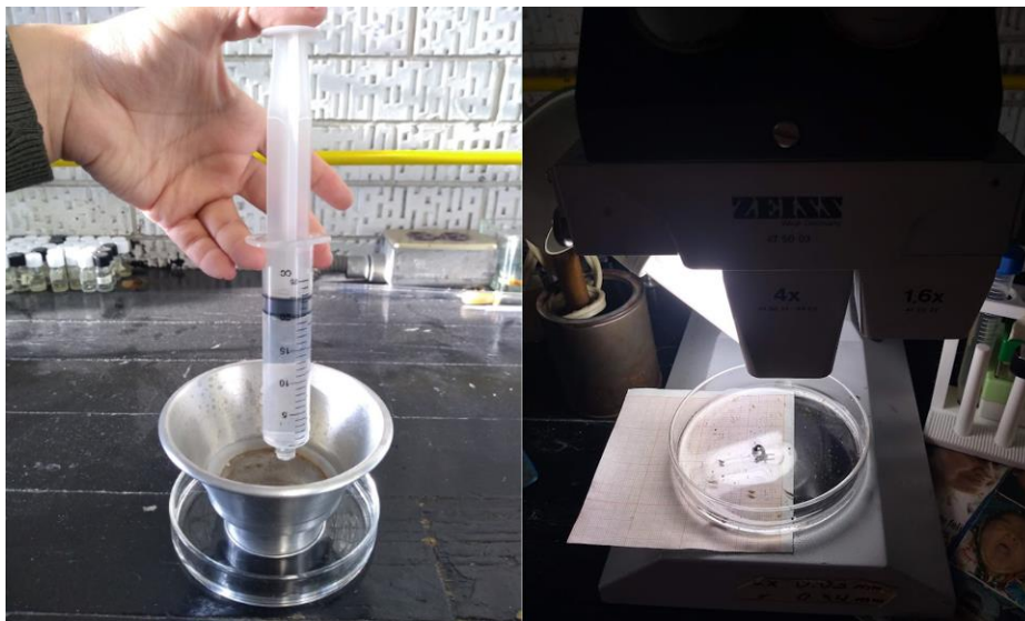
Figura 5. Filtrado con la malla metálica y observación en el microscopio
