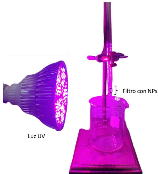
Figura 5.16. Filtro con nanopartículas empleado para la remoción de microorganismo
