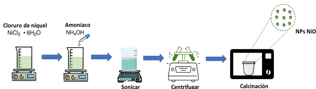
Figura 4.4. Esquema de síntesis nanopartículas de óxido de níquel
