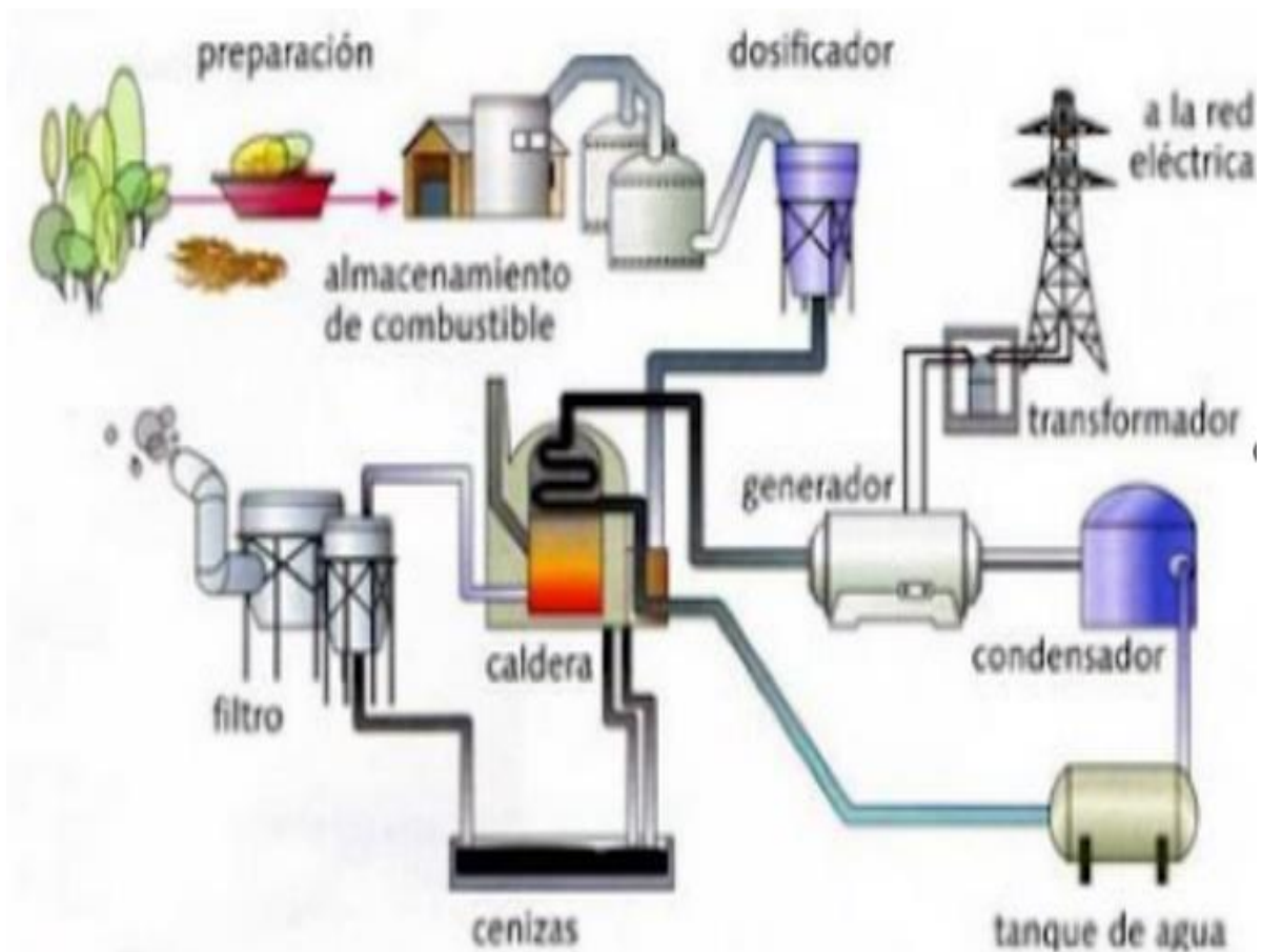
Esquema de una central de biomasa.
