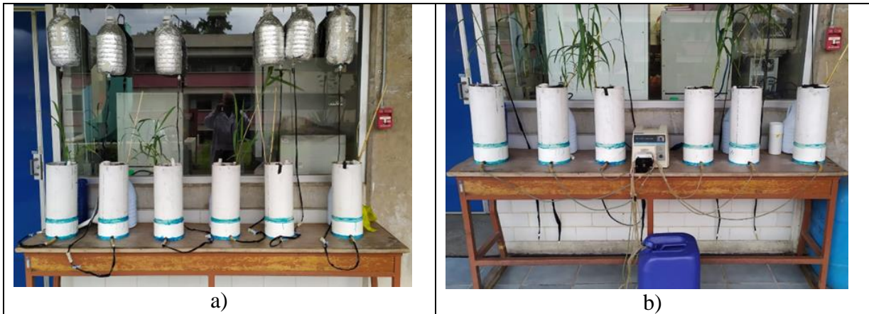
Figura 4.11. Sistemas de alimentación, a) por gravedad, b) mediante bomba peristáltica
