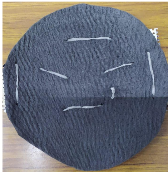
Figura 3.6. Filtro de carbón correspondiente al ánodo. Área del ánodo = 0.020106 m 2
