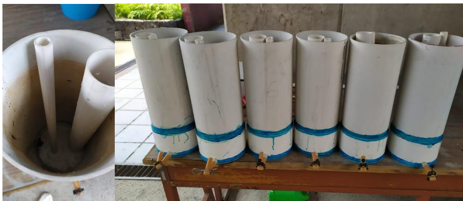
Figura 3.4. Materiales y construcción de la base de los reactores
