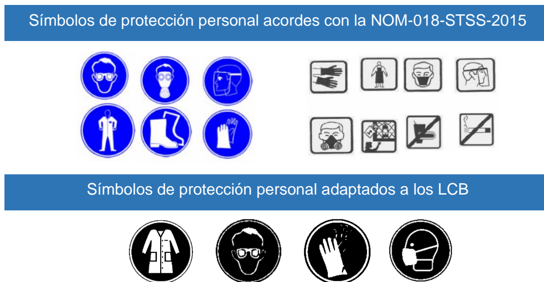
Figura 4.2 Símbolos de protección personal de acuerdo con la NOM-018-STPS-2015 adaptados para los alumnos de los LCB
