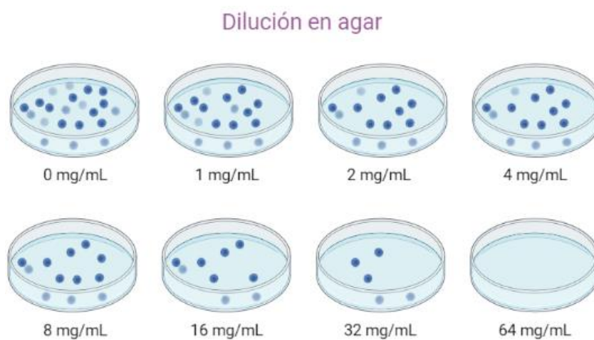
Figura 12. Dilución en agar. La determinación del valor MIC se lleva a cabo encontrando la concentración más baja que no produce crecimiento.
