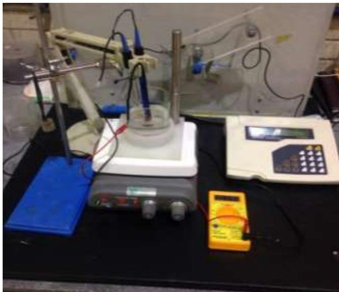
FIGURA 14. Sistema de medición de pH y Potencial de Reposo.
