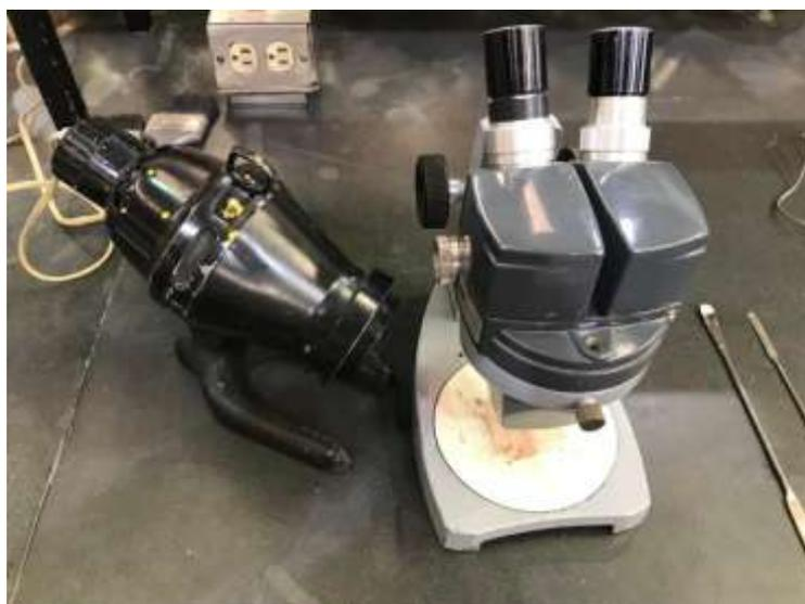
FIGURA 13. Microscopio estereoscópico American Optical modelo AO 570.
