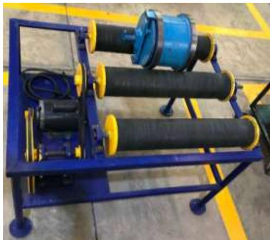
FIGURA 11. Sistema utilizado para la molienda del mineral.
