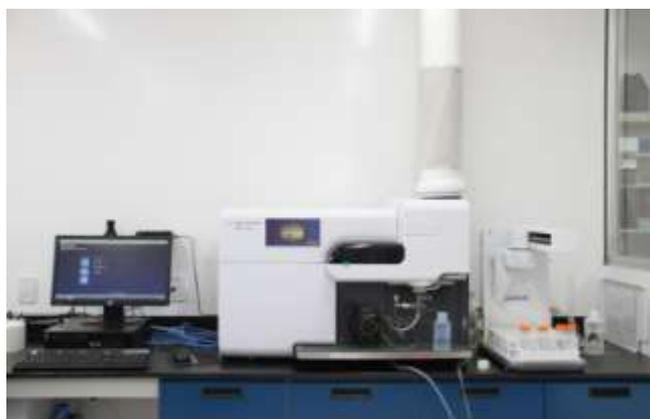
FIGURA 16. Espectrómetro de Absorción Atómica
