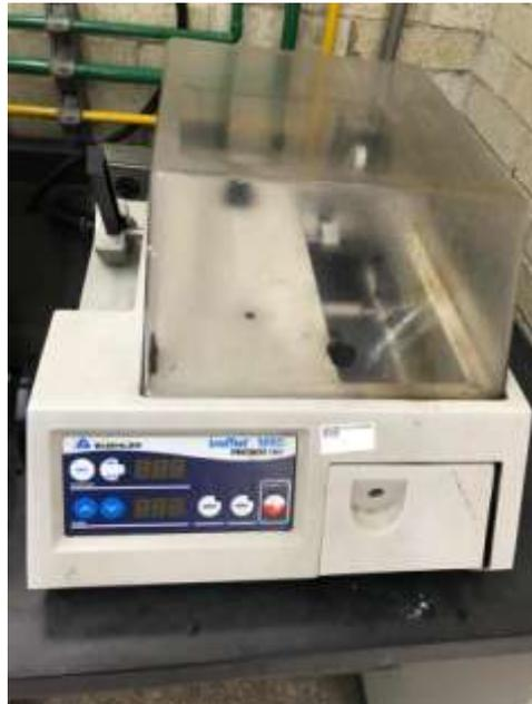
FIGURA 8. Cortadora de disco de diamante para preparar el electrodo de trabajo.
