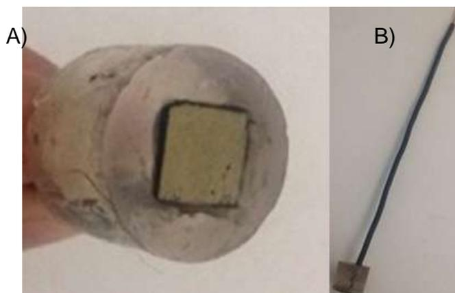
FIGURA 18. A) Electrodo de trabajo de Calcopirita. B) Electrodo de trabajo de Pirita
