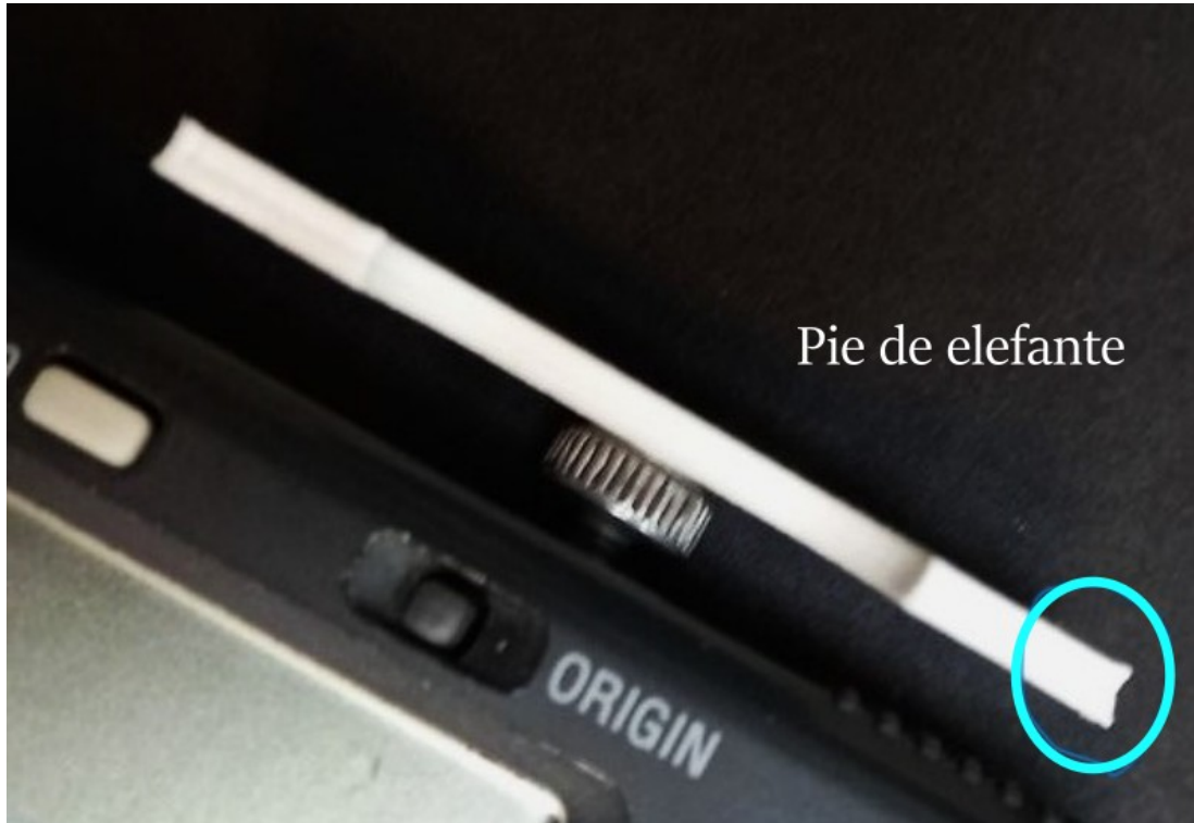
Figura 4.3: Pie de elefante en las primeras impresiones
