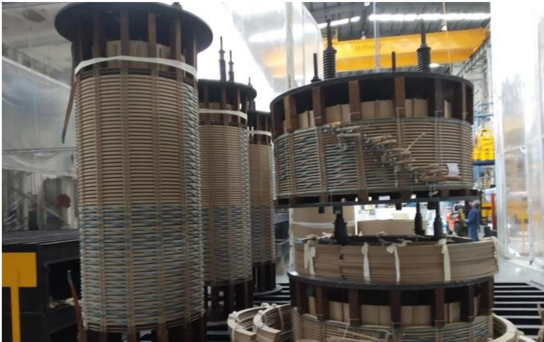
Figura 2.16 Bobinas tipo columna
