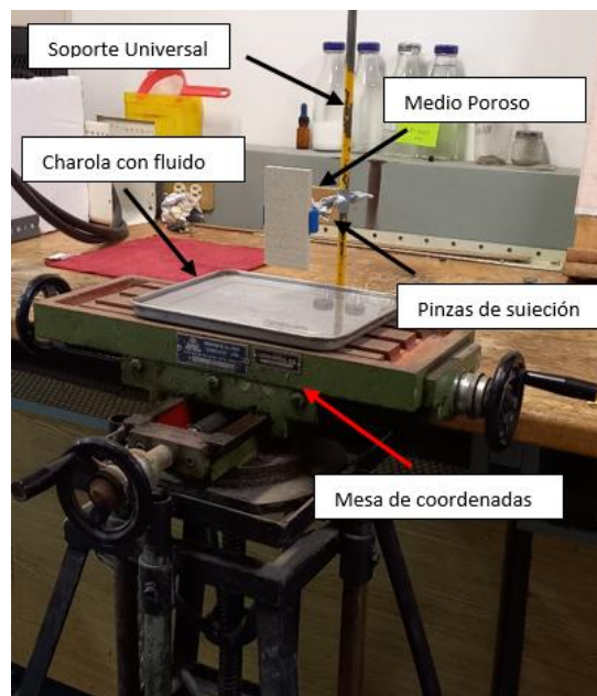
Figura 3.8. Configuración general del experimento.
