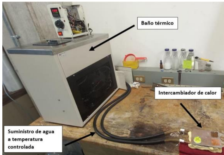
Figura 3.5. Configuración del Experimento
