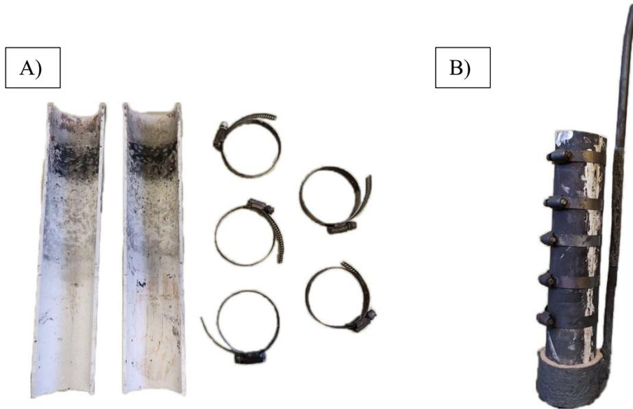
Figura 24 Modificación realizada al dispositivo de fabricación de las espumas: A) partes, B) ensamblado.
