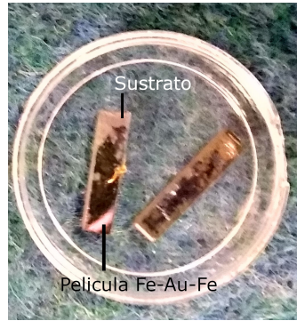
Figura 5.1: Fe-Au-Fe/SiO 2 obtenida con DC a 120 Watts.
