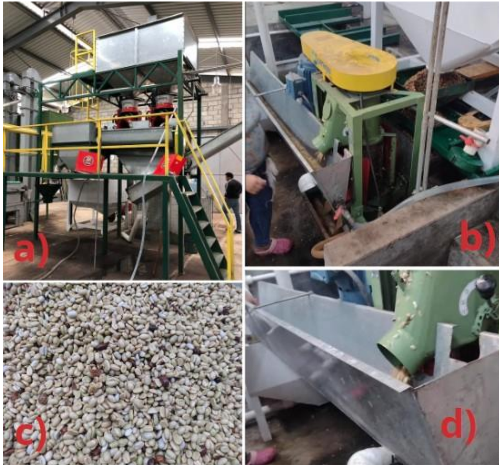
Fig 3.2 Proceso de Beneficio en Teocelo (Elaboración en conjunto con Bello G., 2023). Imágenes: a) Maquinaria para despulpar. b) Equipo desmucilagador. c) Café lavado. d) Canaleta de transporte para mucílago.
