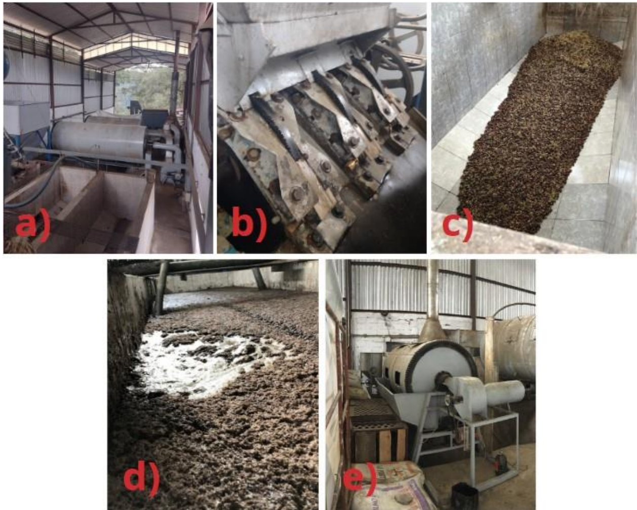
Fig 3.4 Proceso de Beneficio en Ixhuacán de los Reyes (Elaboración en conjunto con Bello G., 2023). Imágenes: a) Vista general de beneficio. b) Despulpadora de 3 discos. c) Tanque de fermentación. d) Tanque de lavado, con aguamiel. e) Hornos rotatorios para secado.
