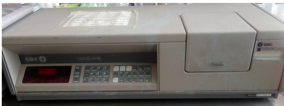
Fig. 20. Espectrofotómetro UV-Vis. Modelo 911 GBC
