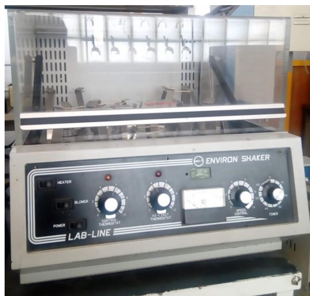
Fig. 31. Incubadora con agitación con temperatura controlada.
