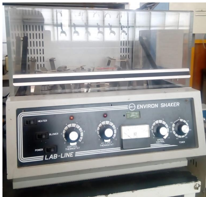
Fig. 21. Incubadora con agitación y temperatura controlada.
