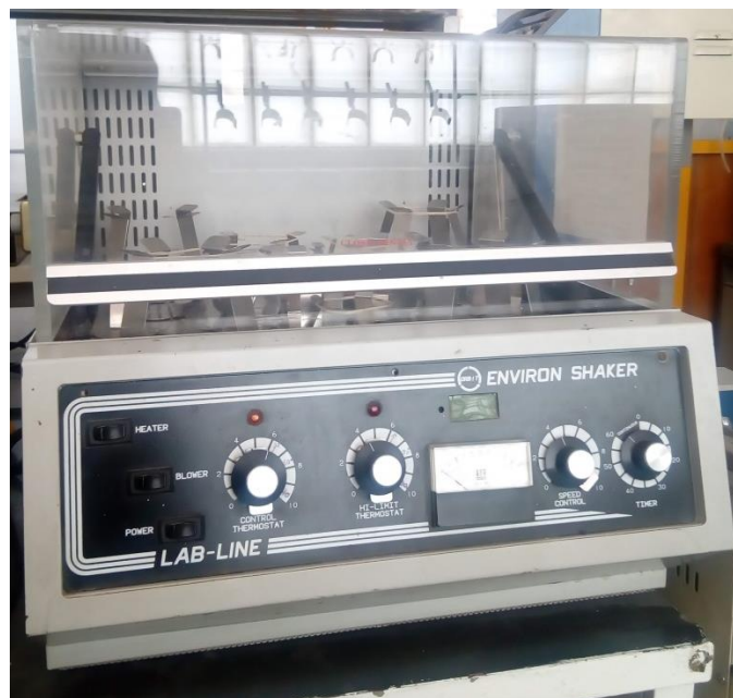
Fig. 18. Incubadora con agitación y temperatura controlada.
