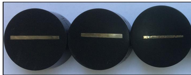
Figura 3.15. Muestras de cada condición montadas en baquelita.
