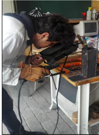
Figura 3.3. Ensamble y soldado de las lingoteras permanentes.
