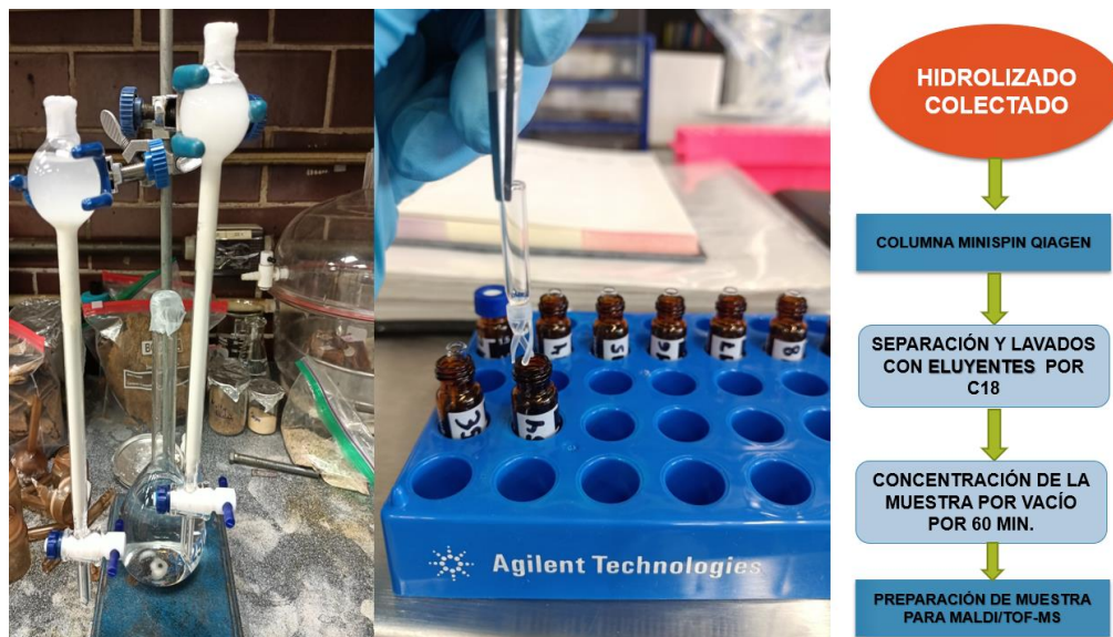
Figura 14. Preparación y purificación de la muestra para ser insertada en el espectrómetro de masas ya que al tratarse de un instrumento de análisis muy fino se requiere un tratamiento previo para poder insertar un analito.
