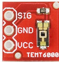
(a) Esquemático del Sensor (b) Sensor de luz ambiental TMMT6000. TMMT6000.
