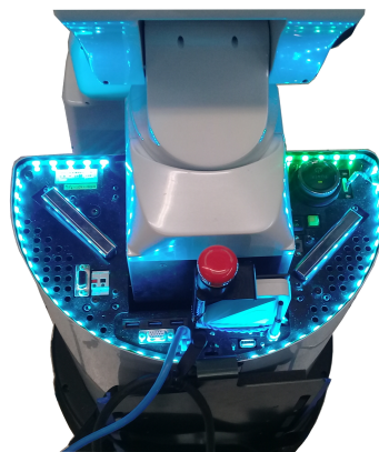
Figura 6.4: Indicadores LED de estado incluidas en el HSR TOYOTA.
