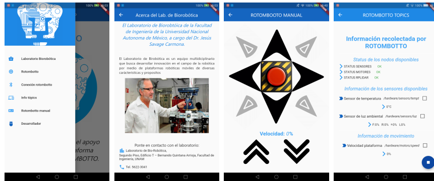
Figura 6.5: Aplicación demostrativa para la interacción con la plataforma robótica móvil.
