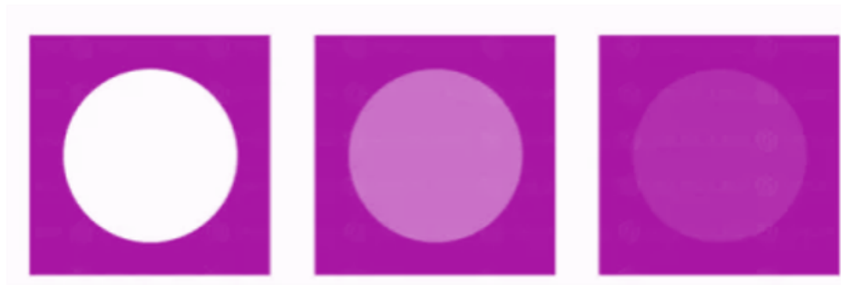
Figura 2.18: Ejemplo de una imagen digital con distinto contraste, de izquierda a derecha el contraste disminuye. Mientras mayor sea el contraste, la diferencia de intensidad de valor de pixel entre dos regiones contiguas será mayor (Modificado de “Cómo Detectar Bajo Contraste en Imágenes con OpenCV” [29]).
