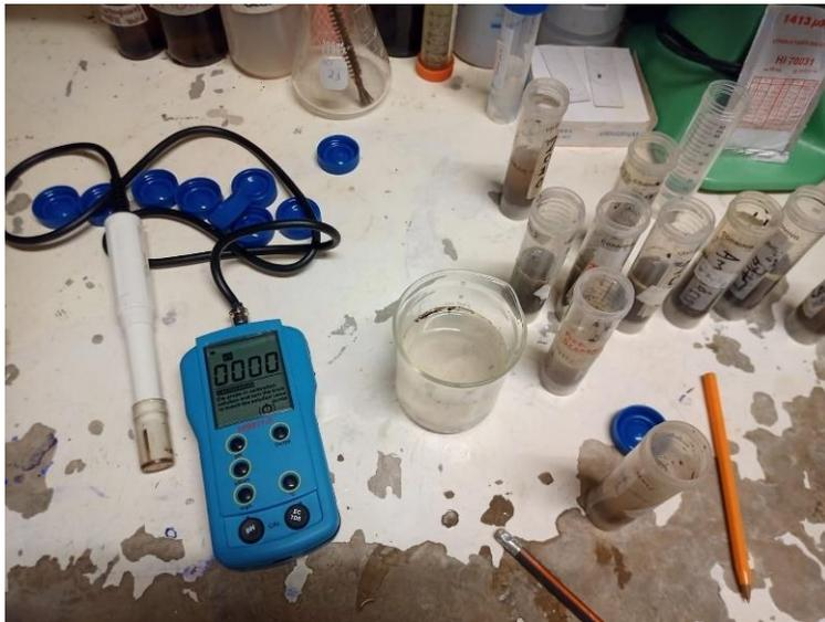
Figura 9. Análisis de Conductividad eléctrica con conductímetro en las muestras de suelo.
