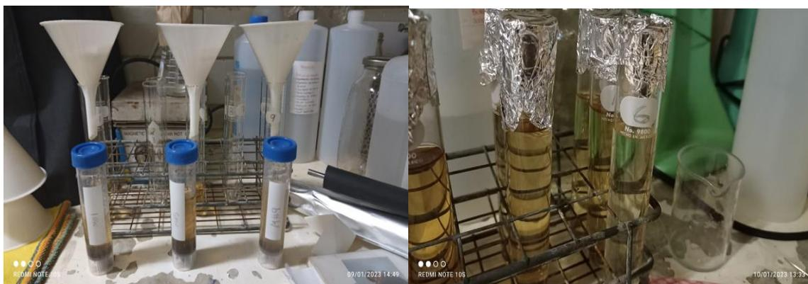
Figura 13. Extracción y filtración de las muestras de suelo para el análisis de fósforo aprovechable.
