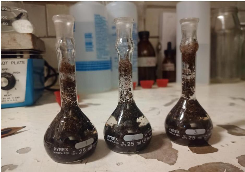
Figura 10. Análisis de densidad real en matraces aforados en las muestras de suelo.
