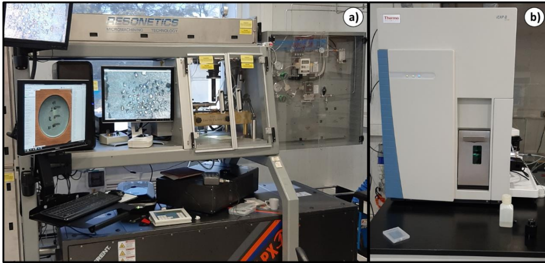
Figura 4.2. Equipo del Laboratorio de estudios isotópicos (LEI) del Centro de Geociencias que se empleó para el fechamiento U-Pb. a) Equipo de ablación laser Resolution M-50/Lambda Physik LPX 220 Excimer. b) Espectrómetro cuadrupolo ICP-MS Thermo Xseriesii.
