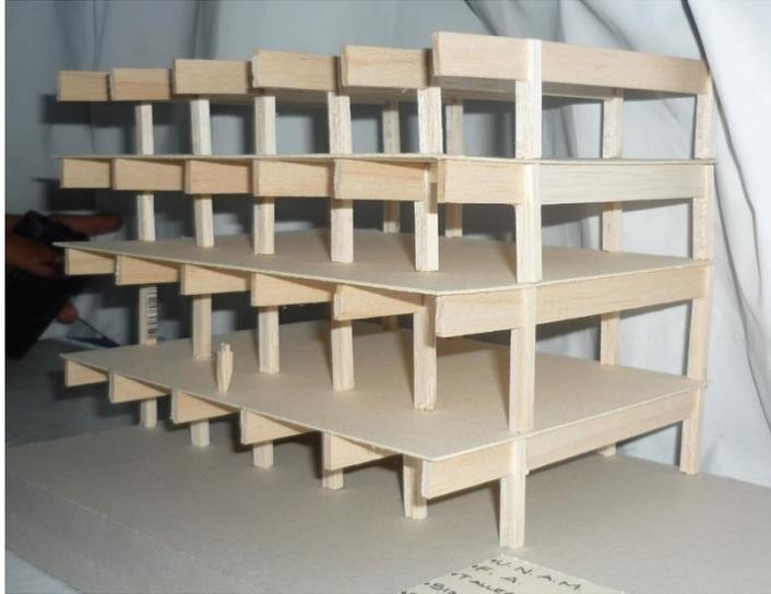
Fig. 2.19 en donde se muestra el sistema de pórticos del Taller Carlos Lazo de la Facultad de Arquitectura de la UNAM. Fotografía por Norma González
