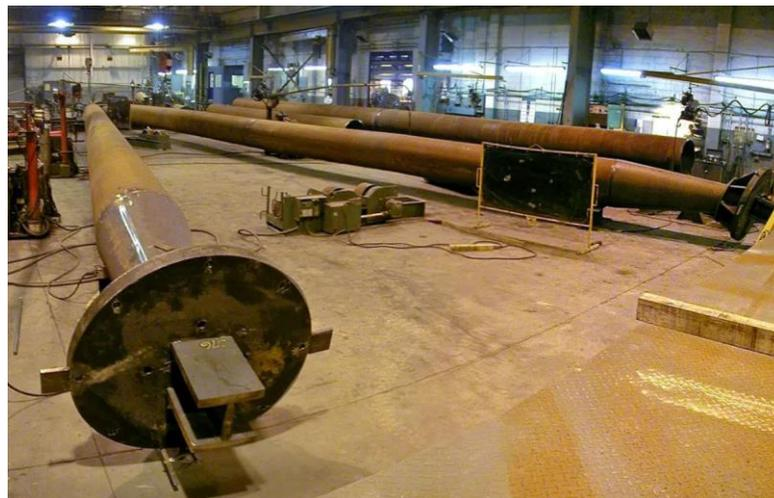
Fig. 5.30 Fabricación de columnas de acero con sus conexiones. *Nota.* Adaptado de <https://www.waltersgroupinc.com/project/ocad/>
