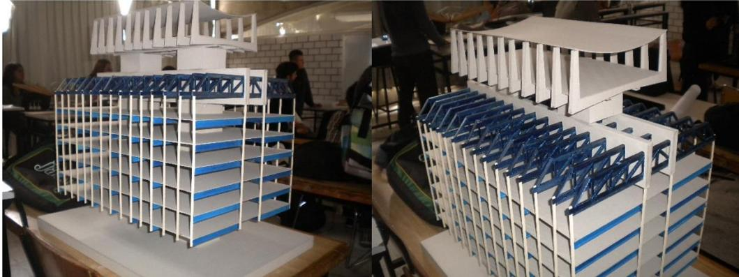
Fig. 2.12 Maqueta elaborada por alumnos de la UNAM en donde se muestra el sistema estructural del edificio Seguros Monterrey y la solución de los entrepisos que cuelgan de una serie de armaduras dispuestas en la parte superior del edificio. Fotografía por Norma González.
