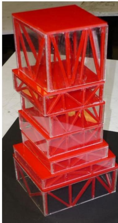
Fig. 2.29 Edificio con sistema de rigidización para edificios altos. Maqueta elaborada por alumnos de la Facultad de Arquitectura UNAM. Fotografía por Norma González.
