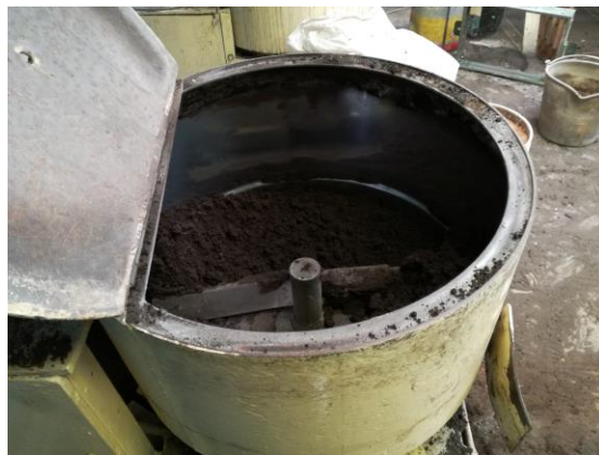
Figura 18. Preparación de la mezcla de moldeo en molino chileno
