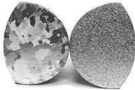
Figura 9. Macroestructura de una aleación de aluminio sin y con tratamiento de refinación de grano
