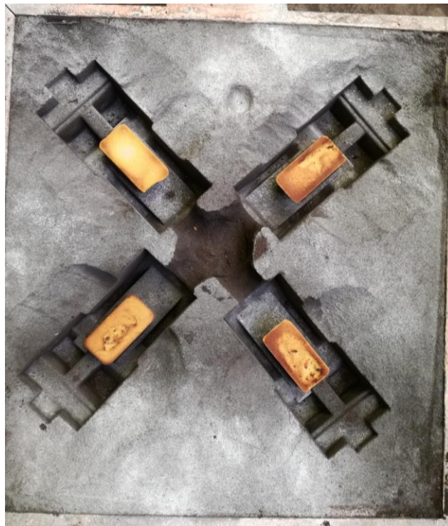
Figura 20. Molde de arena fabricado con cuatro impresiones, con los corazones respectivos.
