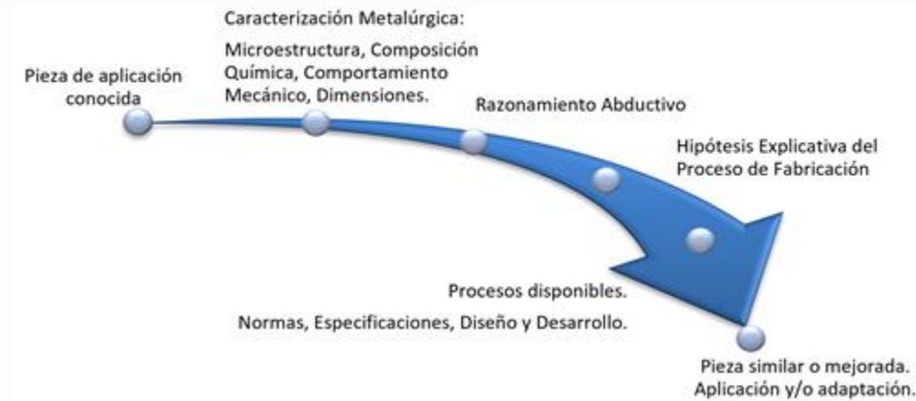
Figura 1. Esquema de la metalurgia inversa
