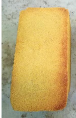
Figura 19. Corazones fabricados por el proceso Shell (cáscara)
