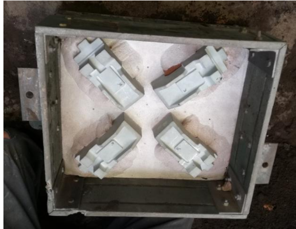
Figura 17. Placa modelo con cuatro modelos
