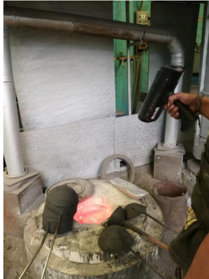
Figura 21. Horno de crisol y medición de la temperatura con termopar tipo K
