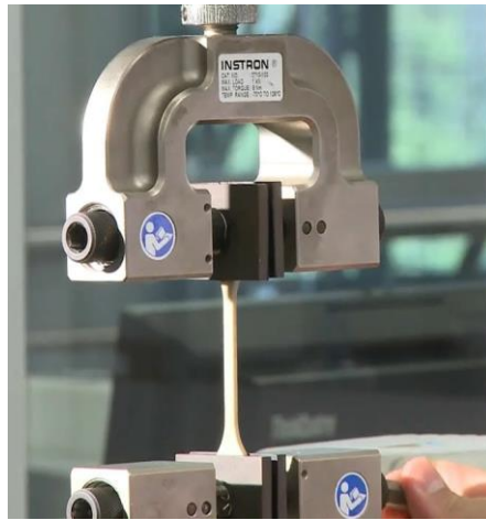
Figura 4. Esquema del ensayo de tensión
