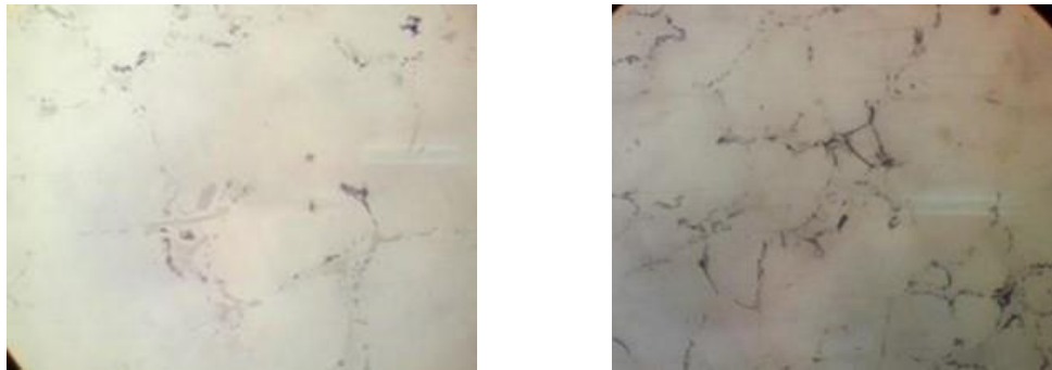
Figura 25. Microestructura de la pieza sustituta en condiciones de colada.
