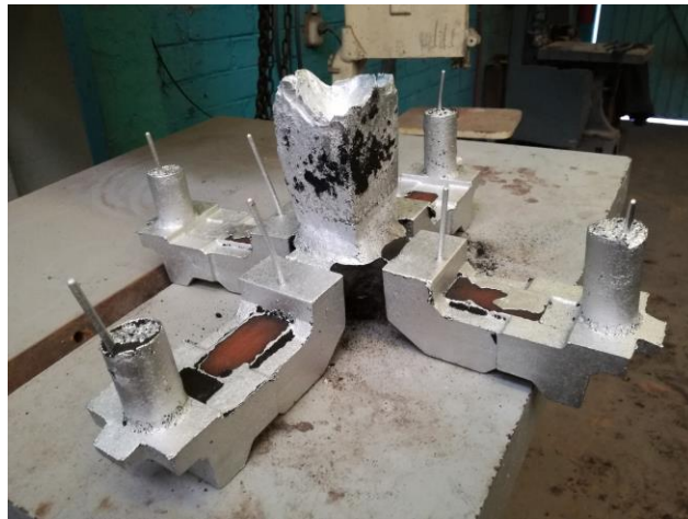
Figura 24. Etapa de desmoldeo y piezas obtenidas por molde
