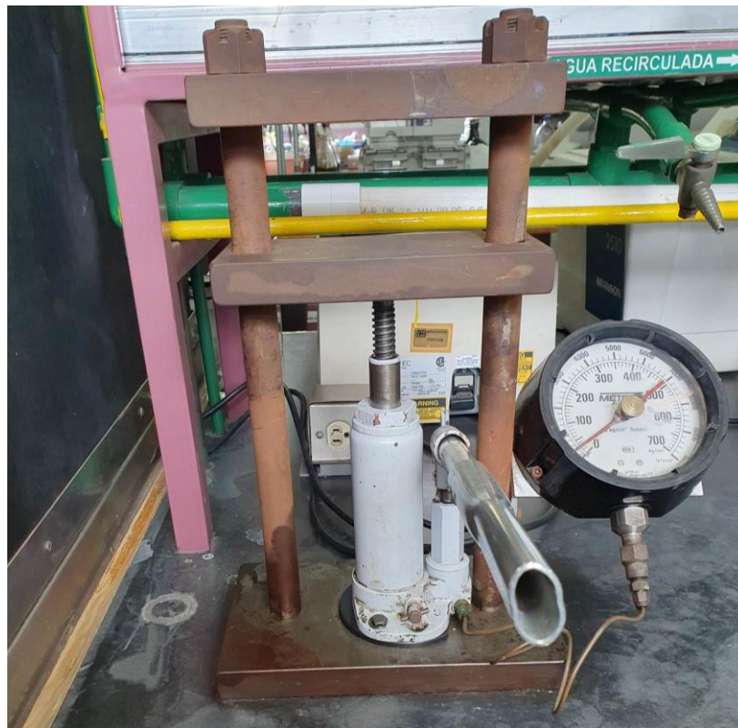
Figura 23. Prensa hidráulica para formar los comprimidos.
