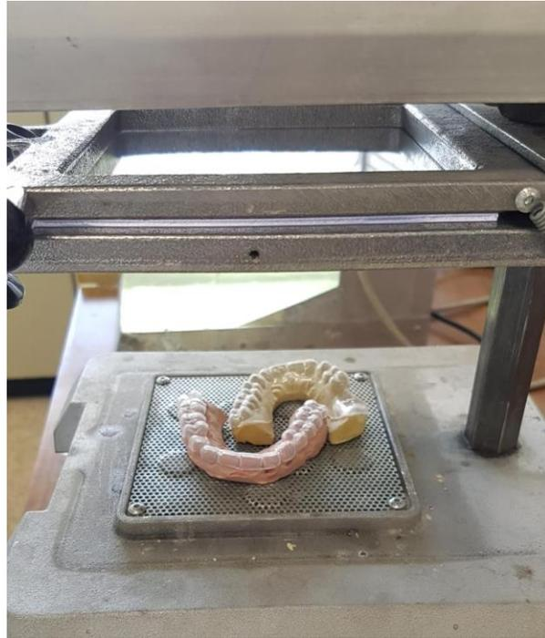
**Figura 22. Acetato rígido calibre 80 calentándose**
