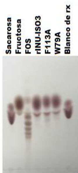
Figura 42. TLC productos de reacción de transfructosilación para las enzimas mutantes F113A y W79A, como control se puso sacarosa, fructosa y FOS en una concentración de 1% m/v y la reacción de transfructosilación de rINU-ISO3.
