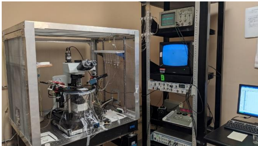
Figura 9. Equipo para realizar los registros electrofisiológicos.
