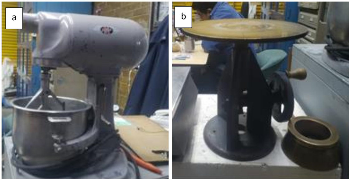
Figura 3.7 a) Mezcladora marca Hobart; b) Mesa de fluidez con platillo de bronce y cono trunco.
